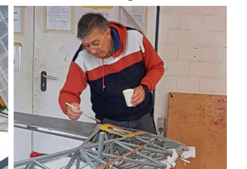
Alexander Willberg streicht die Rohre mit Klebelack ein.
